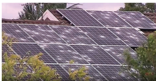
Ilustración 20: Ejemplos de módulo FV con vidrio roto
