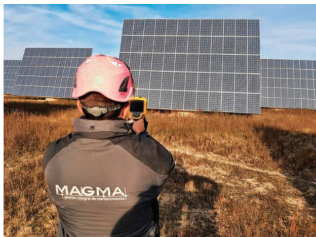
Imagen 4: Equipo técnico de MAGMA realizando un estudio termográfico.
