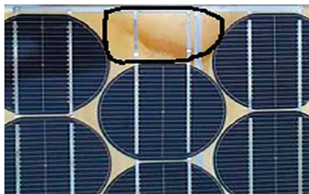
Ilustración 23: Ejemplo de Módulos FV con decoloración. (Fuente: IEEE-TISO, 2008)
