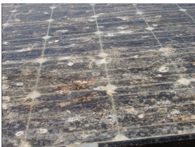
Ilustración 25: Módulos con excrementos y suciedad.
