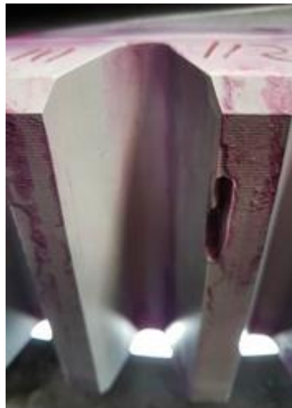
Figura 11: Grietas en corona. Líquidos penetrantes.
