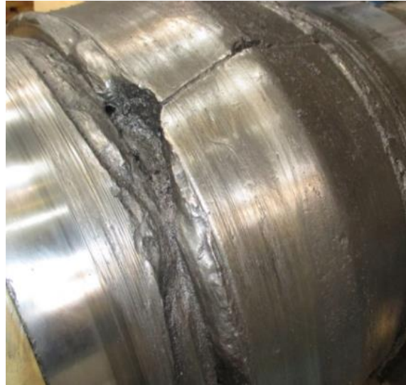
Figura 12 : rodamiento principal dañado.
