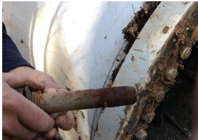
Figura 19: desprendimiento de pala por rotura de pernos
