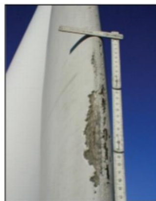
Figura 4: Daño típico en el borde de ataque de la pala (Fuente: INGTEAM/Skillwind)
