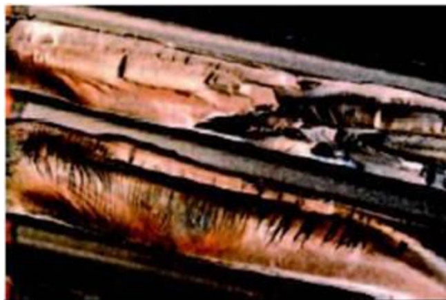
Figura 21: Daños en dientes multiplicadora.
